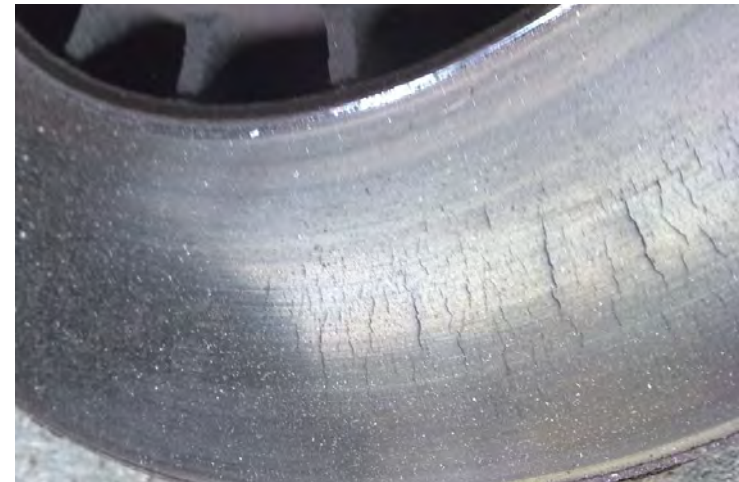
Thermoschock-(Härte-)Risse in einer Bremsscheibe
