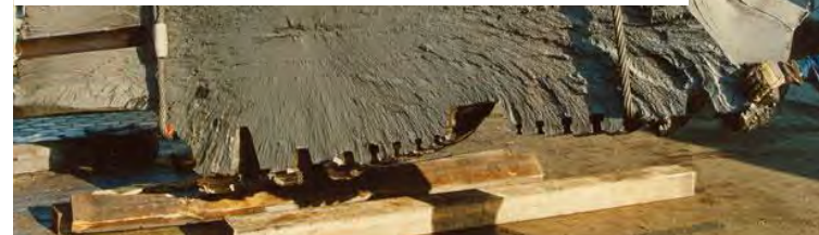
Gebrochene Dampfturbinenwelle (Kraftwerk Irsching)
